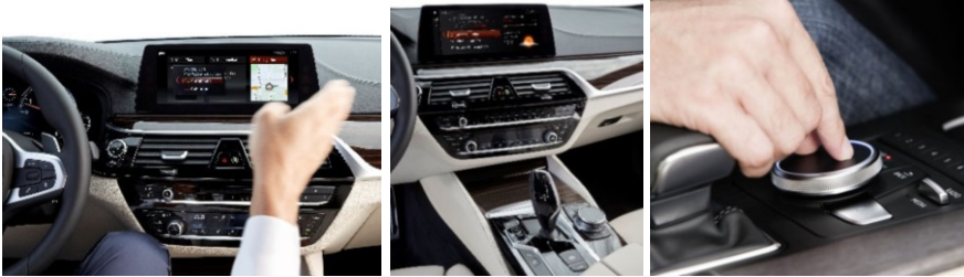
Abbildung 18-2: Links und Mitte: Verschiedene Eingabeelemente in einem Fahrzeug: Lenkradsteuerung unter anderem mit Aktivierung der Sprachkontrolle, Touchscreen, berührungslose Gestenerkennung und iDrive-Dreh-Drücksteller (Quelle: BMW AG). Rechts: Touchpad auf einem Dreh-Drücksteller (Quelle: AUDI AG)
