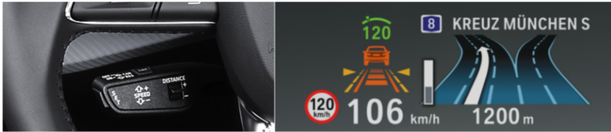
Abbildung 18-4: Links: ACC-Steuerung über einen Hebel am Lenkrad (Quelle: AUDI AG). Wünschgeschwindigkeit: Hebel hoch/runter, Wunschatstand: Kippschalter vorne rechts, Setzen der aktuellen Geschwindigkeit auf Sollgeschwindigkeit: Druck auf die linke Seite. Alte Sollgeschwindigkeit reaktivieren: Ziehen zum Fahrer. Regelung unterbrechen: Druck weg vom Fahrer. Rechts: ACC-Informationen im Head-up-Displays (Quelle: BMW AG). Wünschgeschwindigkeit 120 km/h (oben grün), erkanntes vorausfahrendes Fahrzeug (orangefarbenes Auto) und Wunschatstandsstufe 3/4 (orange Balken)
