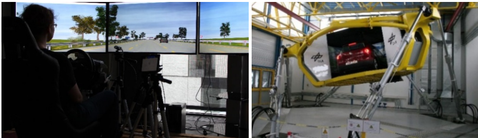
Abbildung 17-6: Fahrsimulatoren. Links: statisches, PC-basiertes System mit drei Monitoren und Eye-Tracking (Quelle: HRW), rechts: dynamischer Fahrsimulator (Quelle: DLR, CC-BY 3.0)
