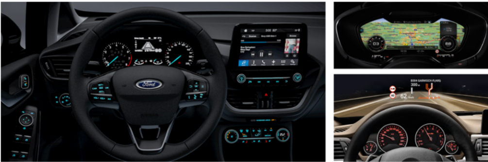
Abbildung 18-1: Verschiedene Displaytypen. Links: Monochromes Display in einem Kombiinstrument mit mechanischen Rundinstrumenten, farbiger Touchscreen zur Multimediasteuerung, segmentiertes Display in der Klimaanlage (Quelle: Ford). Rechts oben: Voll digitales Kombiinstrument (Quelle: AUDI AG). Rechts unten: Head-up-Display (Quelle: BMW AG).
